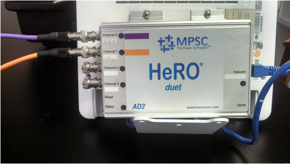
Őekil 2. HeRO duet kablo tesisatı. Mor hasta kablosu en st porta ve turuncu kablo ikinci porta takılmaktadır. AD2'yi HeRO ekranına bir ethernet kablosu baęlamaktadır.
