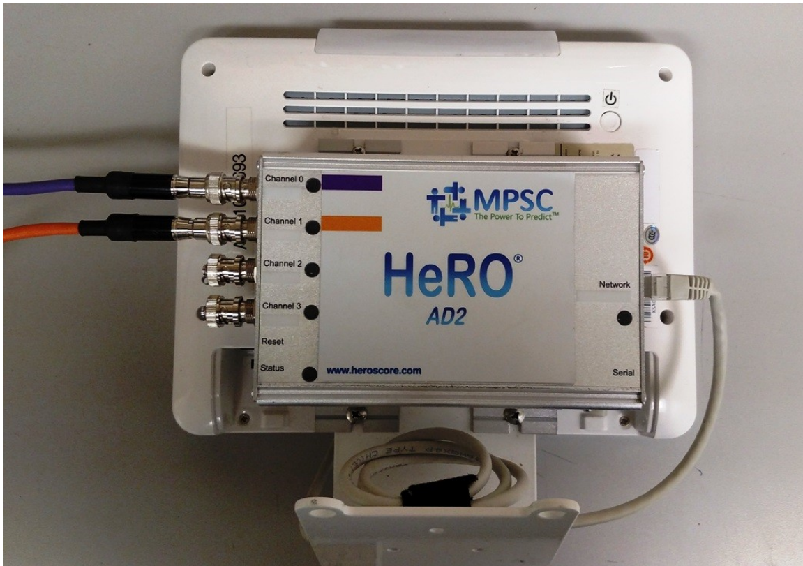
Figure 2b. Câblage du HeRO duet lors de l'utilisation du dispositif d'acquisition de données HeRO (AD2) . Le câble patient violet est inséré dans le port Channel 0 et le câble orange dans le port Channel 1. Un câble Ethernet raccorde le dispositif d'acquisition de données HeRO (AD2) à l'écran HeRO. Le câblage du HeRO solo est identique à l'exception de l'omission du deuxième câble patient orange. Non illustré, les installations RS-232 omettent entièrement le dispositif d'acquisition de données HeRO (AD2) .
