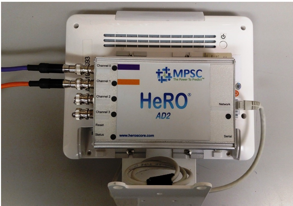
Abbildung 2. HeRO duet-Verkabelung. Das lila Patientenkabel wird an den oberen Port und das orange Patientenkabel an den zweiten Port angeschlossen. Ein Ethernet-Kabel verbindet das HeRO-Datenerfassungsgerät (AD2) mit dem HeRO Display . Die HeRO solo -Verkabelung ist identisch, jedoch fehlt das zweite, orange Patientenkabel. Bei RS-232-Installationen fehlt das HeRO-Datenerfassungsgerät (AD2) komplett.
