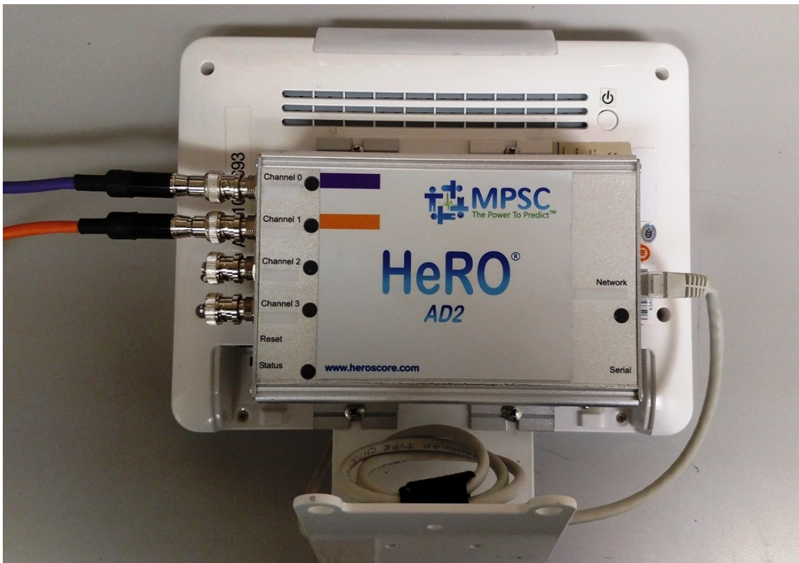
그림 2. HeRO duet 배선. 보라색 환자용 케이블이 상단 포트에 삽입되고 주황색 케이블이 두 번째 포트에 삽입됩니다. 이더넷 케이블은 HeRO 데이터 수집 장치(AD2)를 HeRO 디스플레이에 연결합니다. HeRO solo 배선은 두 번째 주황색 환자 케이블의 누락을 제외하고는 동일합니다. RS232 설치로 인해 HeRO 데이터 수집 장치(AD2)가 완전히 생략되었습니다.
