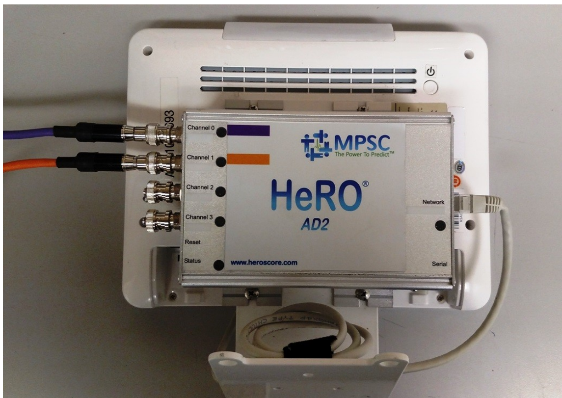
Rysunek 2. Przewody HeRO duet . Fioletowy kabel pacjenta jest podłączony do górnego portu, a pomarańczowy kabel do drugiego portu. Kabel Ethernet łączy HeRO Data Acquisition Device (AD2) z HeRO display. Okablowanie HeRO solo jest identyczne, z wyjątkiem pominięcia drugiego,
