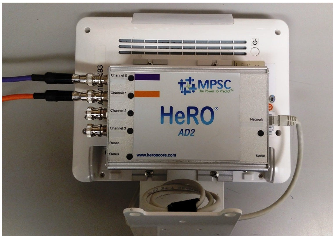
Рис. 2. Кабельные подключения системы HeRO duet . Фиолетовый кабель пациента подключается к верхнему порту, а оранжевый кабель – к второму порту. С помощью кабеля Ethernet устройство сбора данных HeRO AD2 подключается к дисплею HeRO . Кабельные подключения системы HeRO solo аналогичны, за исключением отсутствия второго, оранжевого кабеля пациента. В конфигурации на основе интерфейса RS-232 устройство сбора данных HeRO AD2 отсутствует.
