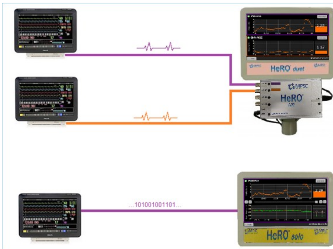
Рис. 1: Общие сведения о системах HeRO solo и duet. Вверху: система HeRO duet в конфигурации для получения аналогового графика ЭКГ с разъемов устройств дефибрилляции/синхронизации на двух мониторах с использованием опционального устройства сбора данных HeRO (AD2) . Внизу: система HeRO solo в конфигурации для получения данных сердечного ритма по интерфейсу RS-232 непосредственно в дисплей HeRO .
